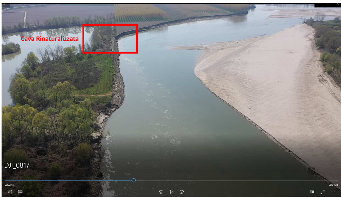
Foto 4. Fenomeni erosivi a carico della sponda del canale secondario a ridosso del margine della cava rinaturalizzata
