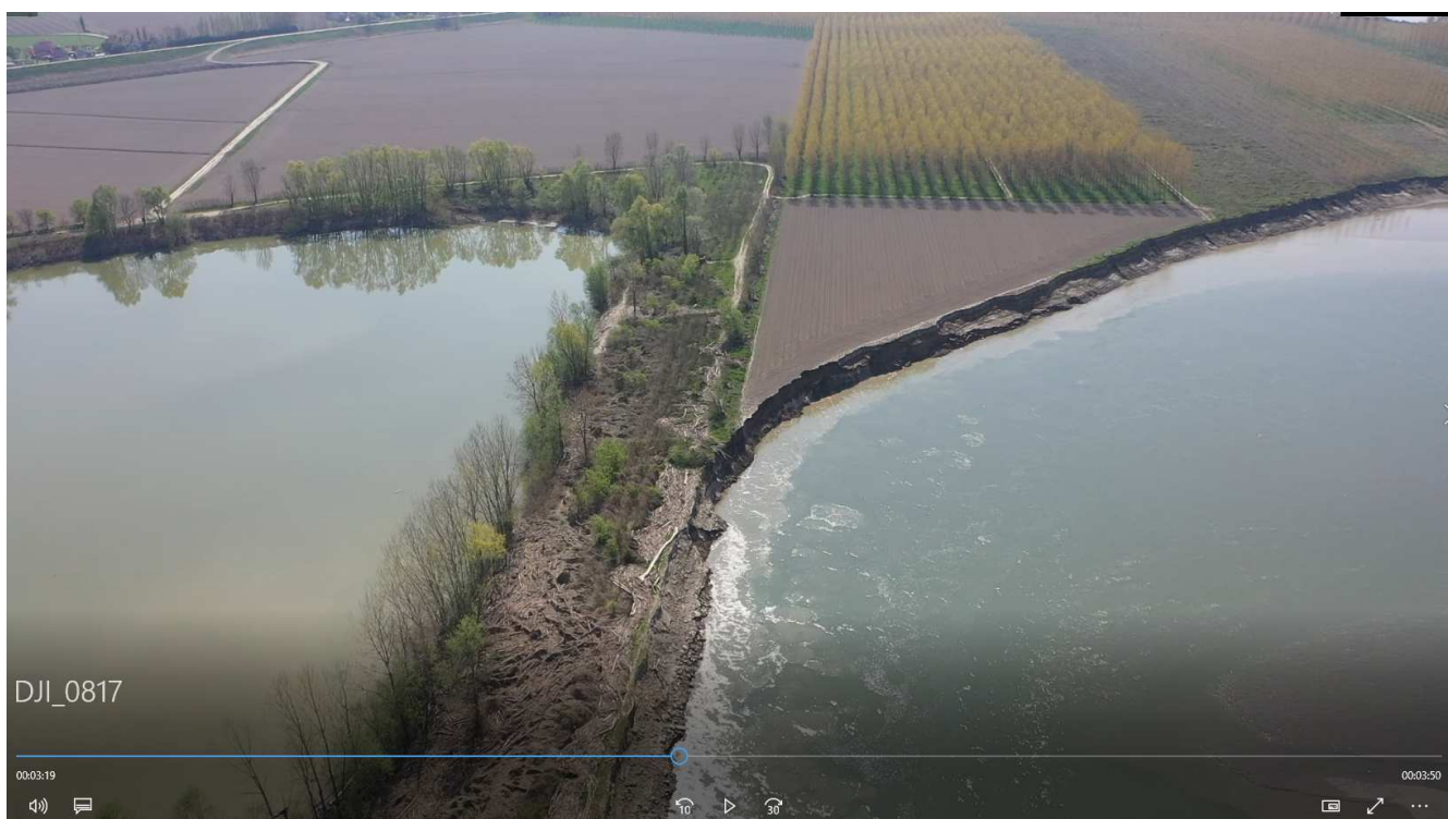
Foto 4. Fenomeni erosivi a carico della sponda del canale secondario a ridosso del margine della cava rinaturalizzata
